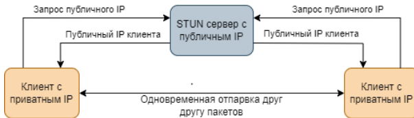
Рис. 2 Принцип работы техники UDP Hole Punching
