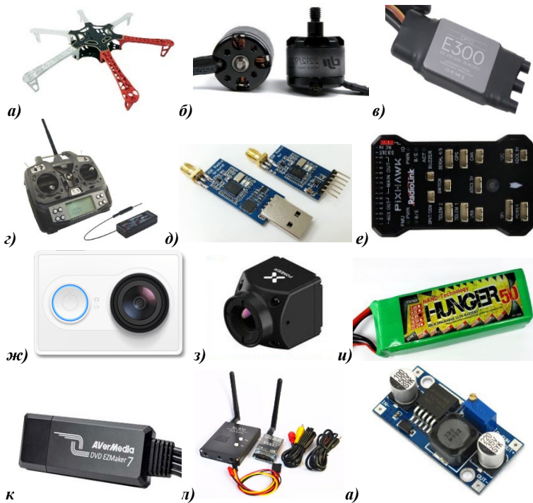
Рис. 1 Внешний вид выбранного аппаратного обеспечения: (а) – рама DJI F500, (б) – моторы DJI 2212, (в) – ЭРС DJI E300, (г) – аппаратра радиуправления Hitec Optic 6, (д) – модули управляющего сигнала 3DR, (е) – полетный контроллер PixHawk PX4, (ж) – камера Xiaomi Yi, (з) – инфракрасная камера FOXEER FT384, (и) – литий-полимерный аккумулятор NanoTech Hunger, (к) – плата видеозахвата AverMedia EZ7, (л) – передатчик и приемник видеосигнала TS832/RC832, (м) – стабилизатор напряжения LM2596
