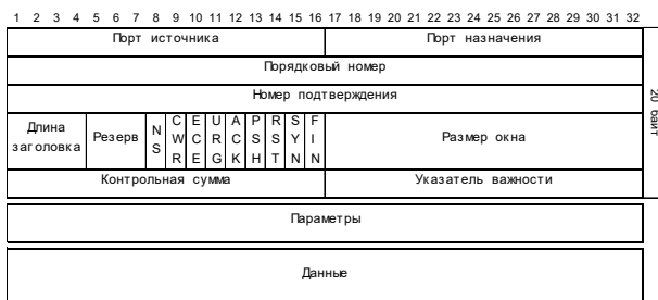
Рис. 1 Структура заголовка пакета TCP
