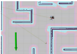
Рис. 7. Иллюстрация зеленой стрелки, указывающей целевую позу для робота назначения робота на rviz2 с помощью 2D_NAV_GOAL.
