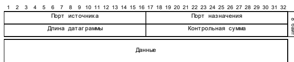
Рис. 2 Структура заголовка пакета UDP
