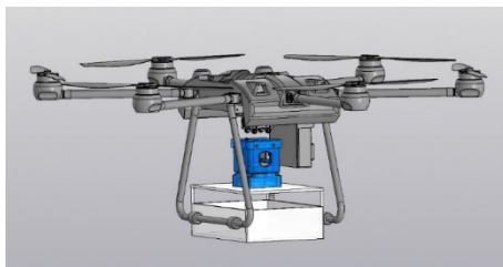
Рис. 3. Беспилотная авиационная система в сборе с системой подвеса грузового контейнера
