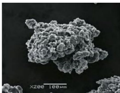
Рис. 1 – Резиновая крошка в битуме до реакции.
