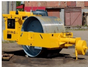
Рис. 2 Прицепной вибрационный каток с жестким гладким вальцом
