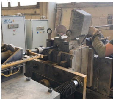
Рис. 2. Заливка сплава в кокиль
