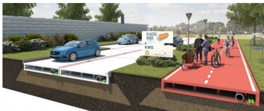
Рис. 1 Дорожное покрытие из пластиковых плит компании VolkerWessels
