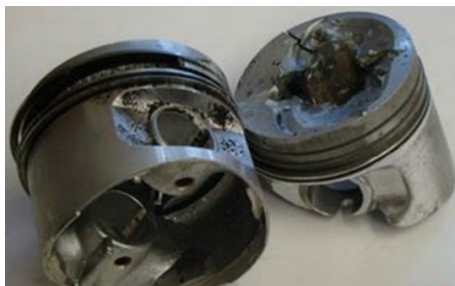
Рис. 2. Последствия неправильной эксплуатации непрогретого двигателя.
