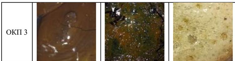
При повышении температуры до 1650°C и 1700°C степень стеклообразования становилась все более выраженной, что указывает на корреляцию между поведением при плавлении и составом КПММ, в частности, наличием оксидов  $RO_2$ ,  $R_2O_3$  и  $R_2O$ .
