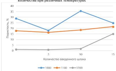
Рис. 2. Зависимости пористости массы с Мариупольским шлаком от его количества при различных температурах
