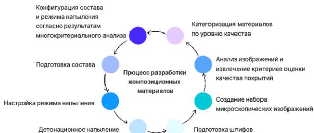
Рис. 4 Модель процесса разработки композиционных материалов
