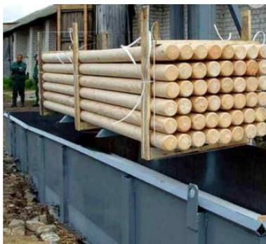
Рис.2 Обработка оцилиндрованного бревна защитными растворами методом окунания.
