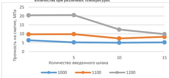
Рис.4. Зависимость прочности на сжатие с Мариупольским шлаком от его количества при различных температурах.
