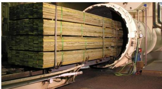
Рис. 3. Камерная термическая обработка древесины.
