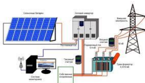
Рис. 1 Принцип работы солнечной батареи
