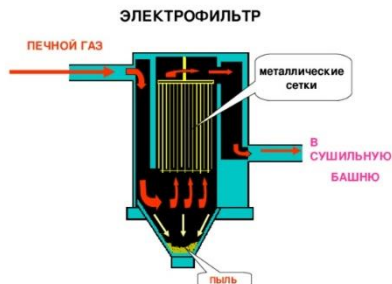
Рис. 3 Схема работы электрофильтра
