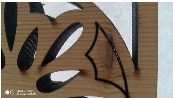
Рис. 2 Из-за недостатка мощности лазерного луча место с сучком обработалось не полностью.
