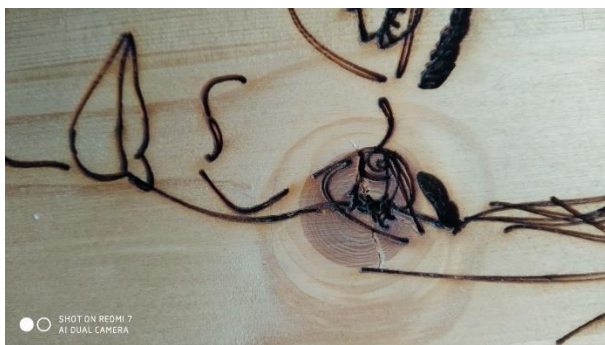
Рис. 1 При интенсивном режиме гравирования возникают подгорания соседних участков.
