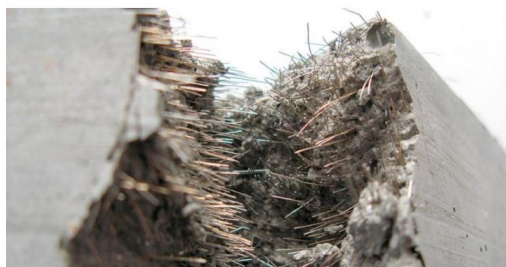
Рис. 1. Фибробетон (вид в разрезе) с добавлением металлической фибры
