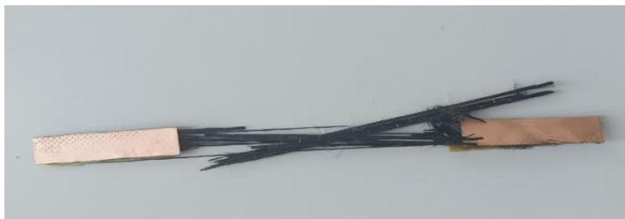
Рис. 3 Разрыв волокон на испытательном стенде
