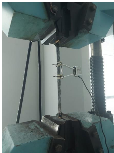
Рис. 1 Испытание углепластикового волокна
