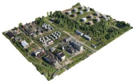
Рис.4 – Трехмерная модель, полученная в результате обработки данных с БПЛА
