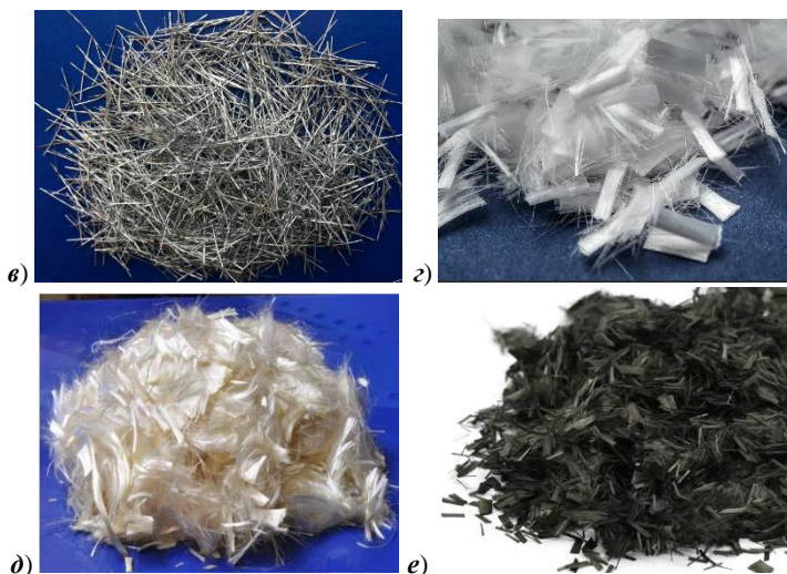
Рис. 1 Виды фибры: а) стальная; б) стеклянная; в) базальтовая; г) синтетическая полипропиленовая; д) акриловая; е) углеродная
