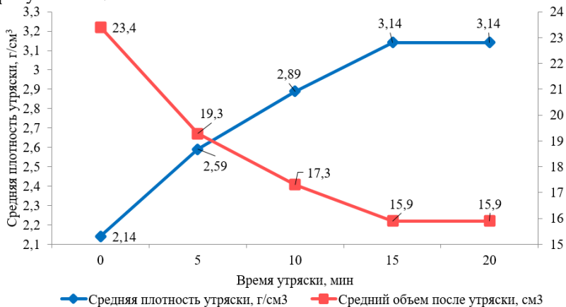
Рис 1 – Зависимость средней плотности утряски немодифицированной механической смеси Ti-2C-W от времени встряхивания
