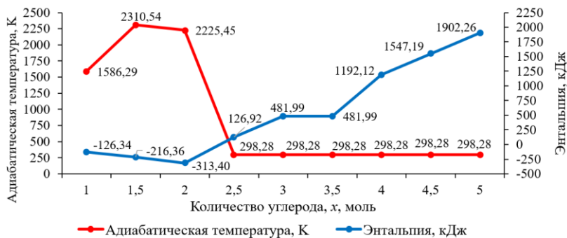
Рис. 3 – Результаты термодинамического анализа состава Ti-C-W при увеличении содержания углерода
