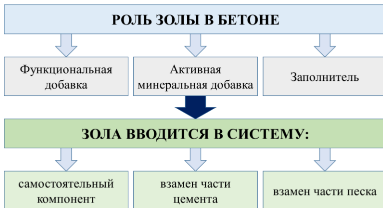
Рис. 1 Роль золы в системе бетонных композитов
