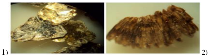
Рис.1. Образцы природного (1) и вспученного (2) вермикулитов
