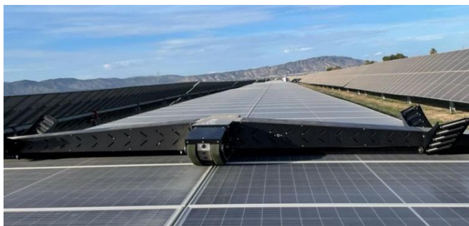
Рис. 1 Автономный робот-уборщик SandStorm
