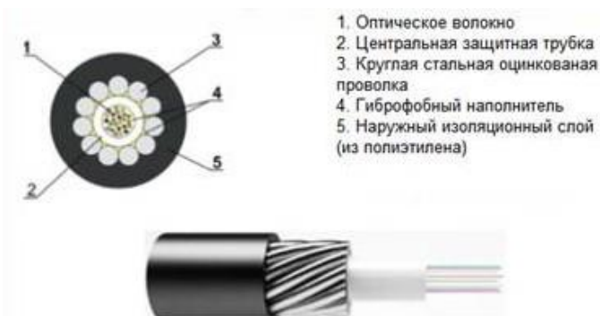
Рис. 2 Структура оптоволоконного кабеля
