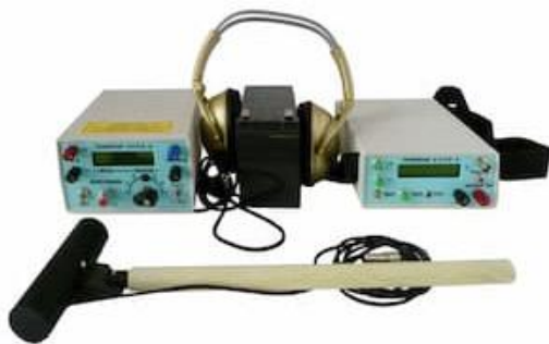
Рис. 3 Прибор АНПИ (РФ) для нахождения поврежденного участка изоляции
