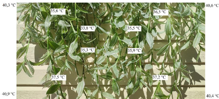
Рис. 1 Результаты измерения температуры стены при наличии и отсутствии «зелёного» экрана (Традесканция)
