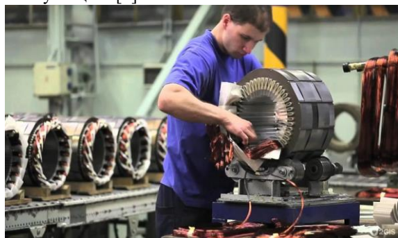
Рис. 1 Процесс обмотки электрических машин
