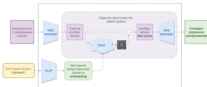
Рис. 1 Схема структуры архитектуры Stable Diffusion
