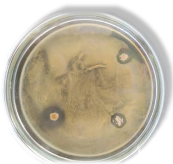
Рис. 3 Определение антибактериальных свойств гибридных материалов
