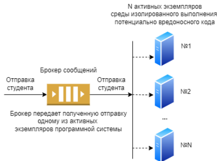
Рис. 2 Схема работы системы с использованием брокера сообщений
