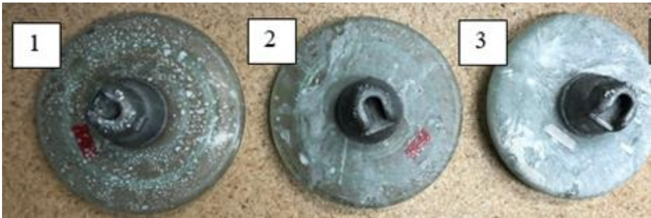
Рис. 2. Искусственно загрязненные изоляторы и разбитый изолятор: 1 - «нормальное» состояние изолятора (плотность покрытия 0,06 \text{ мг/см}^2 ); 2 - «ухудшенное» состояние изолятора (плотность покрытия 0,2 \text{ мг/см}^2 ); 3 - «предаварийное» состояние изолятора (плотность покрытия 0,4 \text{ мг/см}^2 )
