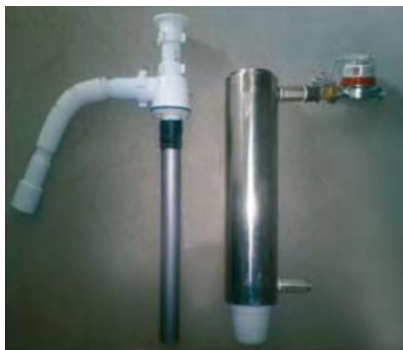
Рис. 1. Теплообменник-утилизатор, устанавливаемый на сифон.
