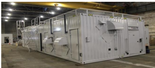
Рис.2 Автономный энергокомплекс ЭНЕРГО-К14/2М5.2.G60-2,5
