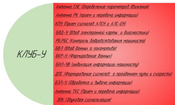
Рис. 1 Структурная схема комплексного локомотивного устройства КЛУБ-У
