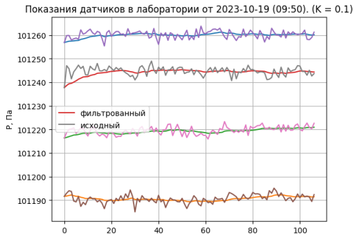
Рис. 2 График исходного и фильтрованного сигнала давления воздуха, измеренного в лабораторных условиях
