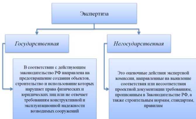
Рис. 1 Виды строительной экспертизы
