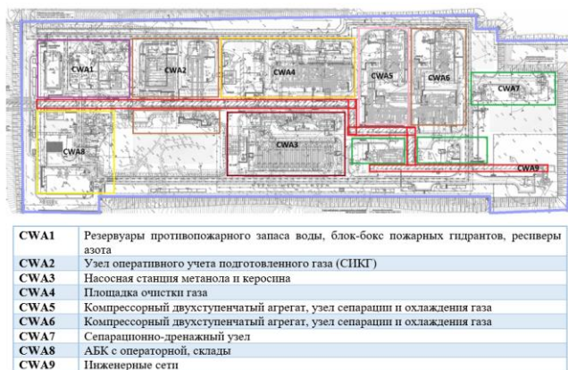
Рис. 1 Деление объекта на строительные зоны (CWA)
