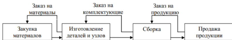
Рис. 1. Схема организации производства и продаж по JIT
