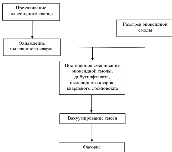
Рис. 2 Технологическая схема производства заливочного компаунда на основе эпоксидной смолы
