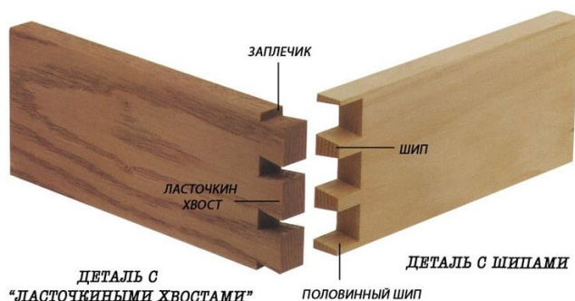
Рис. 2 Соединение конструкций типом «Ласточкин хвост»
