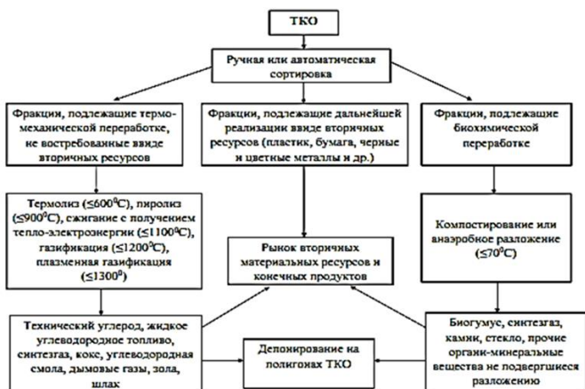
Рис. 1. Схема классификации существующих способов переработки органических ТКО по направлениям.
