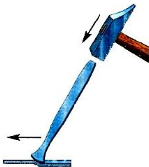
Рис. 2 Прием работы чеканом
