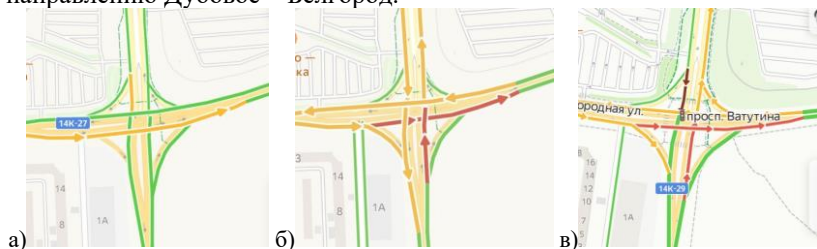
Рис. 2. Загрузка движением по направлению Дубовое – Белгород (а – утро, б – обед, в - вечер)
