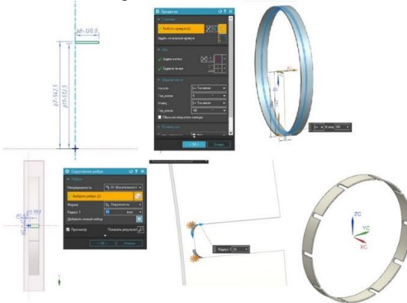
Рис. 3 Создание эскиза и построение обечайки
