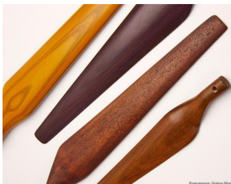
Рис. 1. Готовые изделия разного вида пород, созданные 3D печатью древесиной
