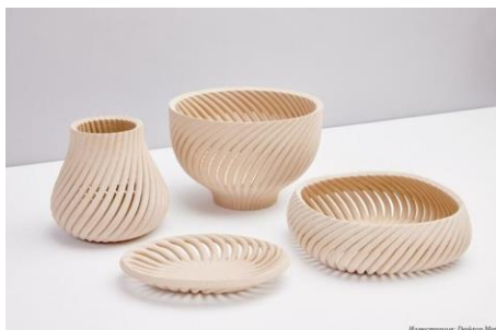
Рис. 3. Готовые изделия с помощью 3D печати, которые невозможно создать традиционными методами
