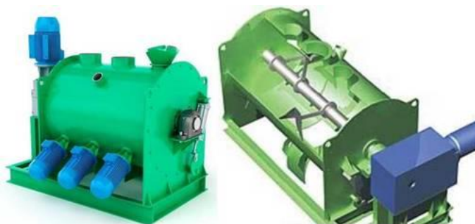
Рис. 1 Внешний вид и внутреннее устройство смесителя «СМ ТУРБОМИКС»
