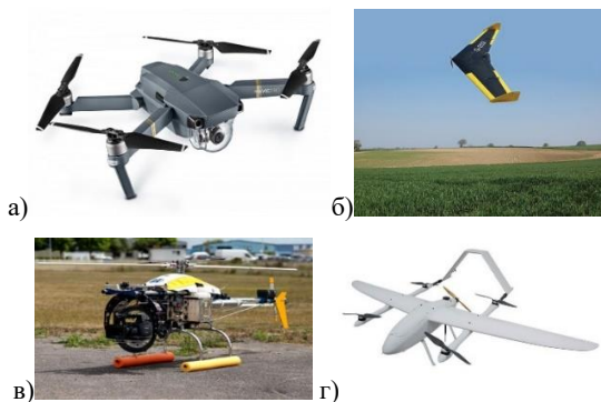
Рис.1. 4 основных типа беспилотных летательных аппаратов: а – мультироторные; б – с неподвижным крылом, в – однороторный; г – гибридный тип.
