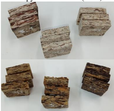
Рис. 1 Плитные материалы из отходов оцилиндровки бревен до и после испытания
