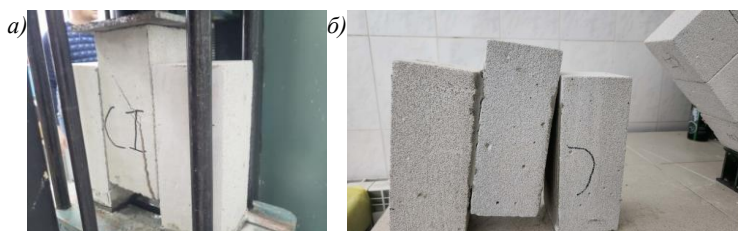
Рис. 4. Общий вид образцов после испытания на срез: а – разрушение по «телу» призмы; б – разрушение по клеевому шву
