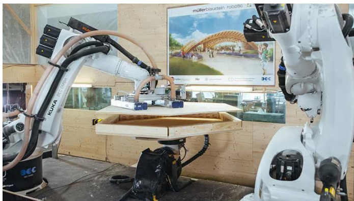
Рис. 1. Сборка роботами элементов павильона [5]
