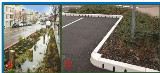
Рис. 4 Пример декоративного дренажа и дренажа под тротуаром
