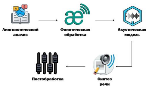
Рис. 1 Принцип работы Text-To-Speech
