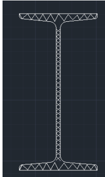
Рис. 2 Разбиение сечения испытуемого образца на сеть конечных элементов
