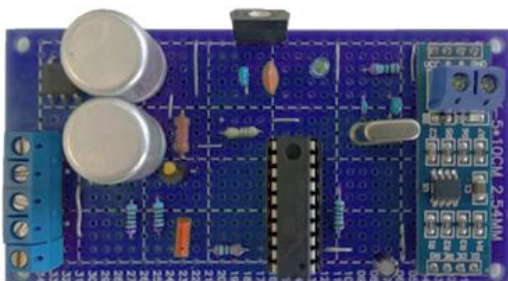
Рис. 3 Собраный рабочий прототип платы управления на макетной плате
