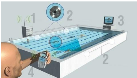
Рис. 1 Система безопасности для бассейна Angel Eye: 1 – центральный блок управления; 2 – подводная камера; 3 – монитор; 4 – смартфон и смартчасы
