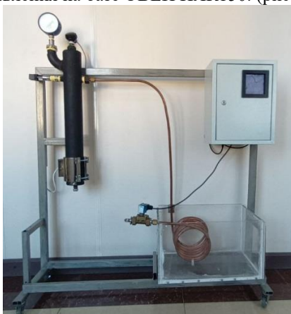
Рис. 1 Внешний вид учебно-лабораторного стенда по изучению процессов регулирования температуры и давления на базе ОВЕН ПЛК150
