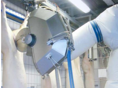
Рис. 1 Роботизированная ячейка по выполнению первичного разреза туши для операции нутровки от компании Marel Meat
