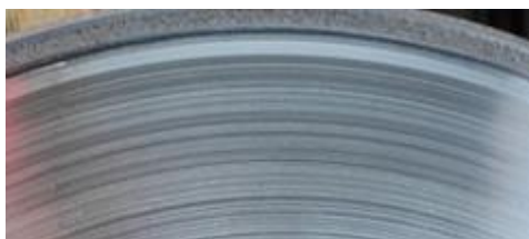
Рис. 2 Прижоги слоя ПКМ металл-композитной системы при шлифовании
