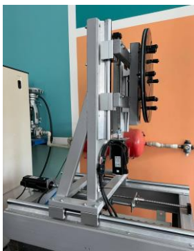
Рис. 4 Фотография разработанного мехатронного узла подачи заготовок в зигмашину
