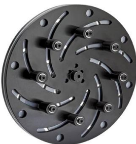
Рис. 5 Самоцентрирующийся патрон Лонгворта
