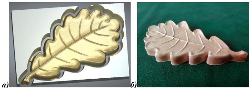
Рис. 7 Пример эмуляции (а) и фото готовой фигуры листа дуба (б).
