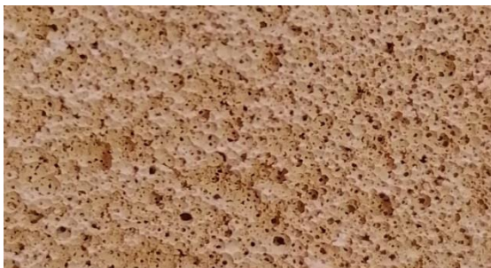
Рис. 1 Структура пор пенодиатомитового легковеса
