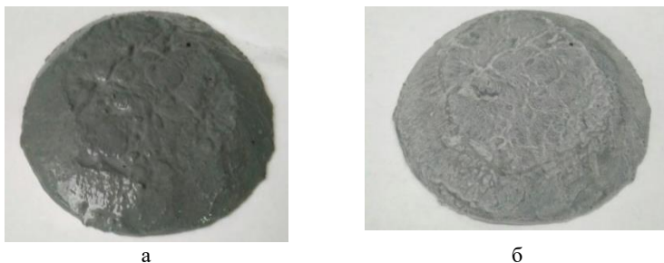
Рис. 1 Проба на равномерность изменения объёма: а – до пропаривания; б – после пропаривания
