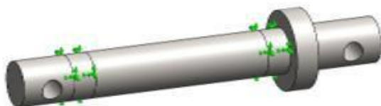
Рис. 2 Поверхности, зафиксированные в расчетах на изгиб
