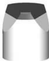
Рис. 1 Зубья режущих конусов плуга
