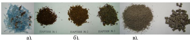
а). б). в). Рис. 1 Вторичное сырье из бытовых отходов: а).- измельченный вторичный полиэтилен; б).- обработанные пищевые отходы; в).- измельченные и гранулированные целлюлозно-бумажные отходы.
