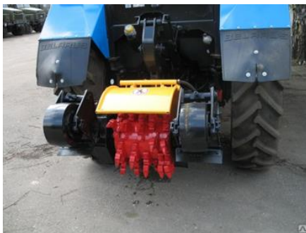
Рис. 1 Дорожная фреза на базе трактора МТЗ-82.1
