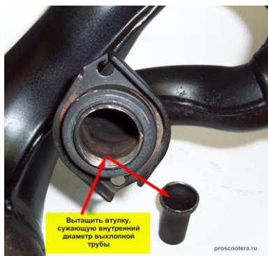
Рис. 1 Ограничитель скорости в выпускной системе двигателя 139QMB
