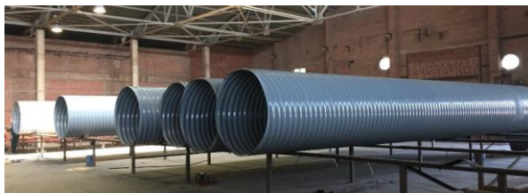
Рис. 3 Секции спиральнолитых металлических гофрированных труб
