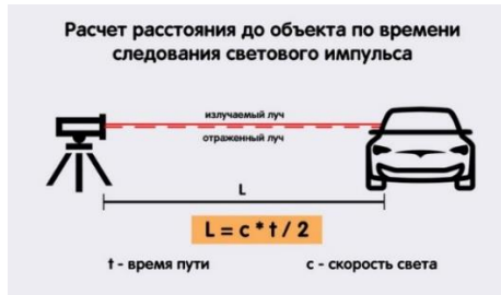
Рис. 1 Расчет расстояния до объекта по времени следования светового импульса
