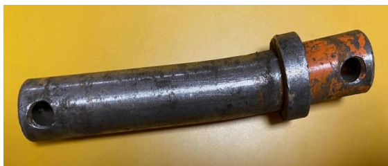
Рис. 1 Состояние изгиба предохранительного пальца после использования
