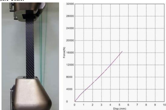
Рис. 1 Тест карбоновой ткани на растяжение (1 Н = 0,102 кгс)
