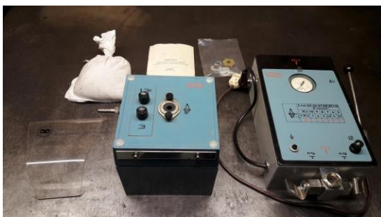
Рис. 1 ГАРО Э203 — стенд для проверки свечей зажигания
