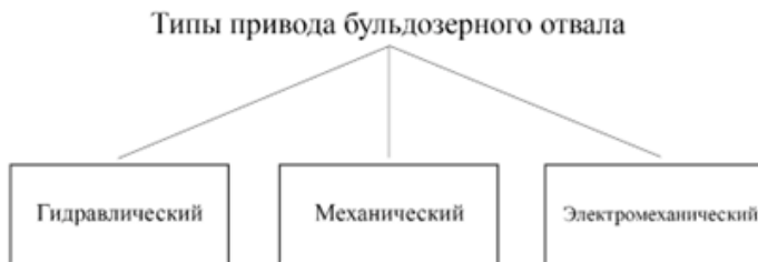
Рис. 1 Типы привода бульдозерного отвала
