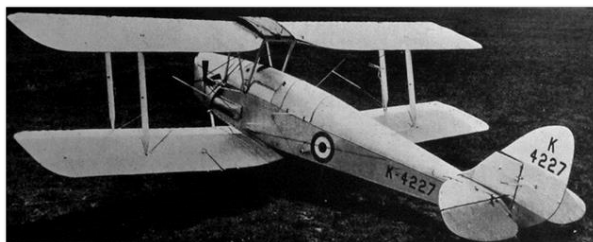
Рис. 1 Первый беспилотный летательный аппарат Н.82В Queen Bee
