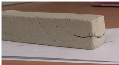
Рис. 3 Образец теплоизоляционного пеногазобетона на основе портландцемента (ЦЕМ I 42,5 Н)
