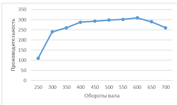
Рис. 4 Зависимость производительности гранулирования цементной пыли от числа оборотов ведущего вала гранулятора
