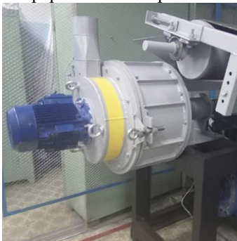
Рис. 2 Роторно-вихревая мельница ММУ-460
