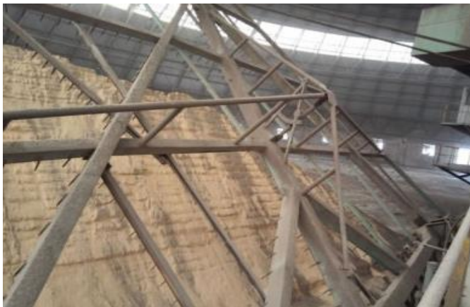
Рис. 2 Активная (сгребающая) борона
