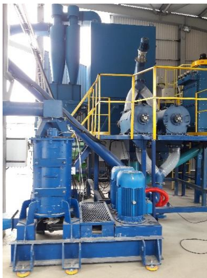
Рис. 4 Роторно-вихревая мельница РВМ-3000М в составе помольного комплекса
