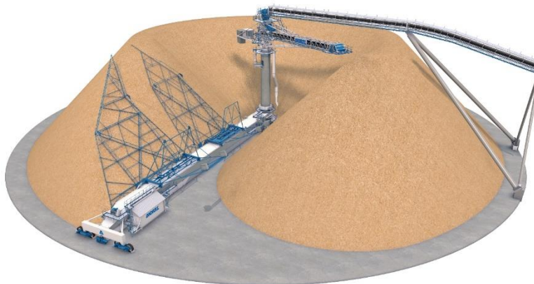
Рис. 1 Схема радиального стакера-реклаймера
