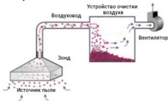
Рис. 1 Компоненты системы сбора пыли
