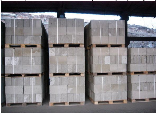
Рис. 2 Транспортировка керамзитобетонных блоков
