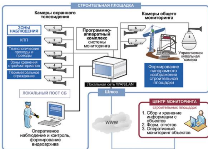
Рис. 1 Структура телемониторинга строительной площадки [6]
