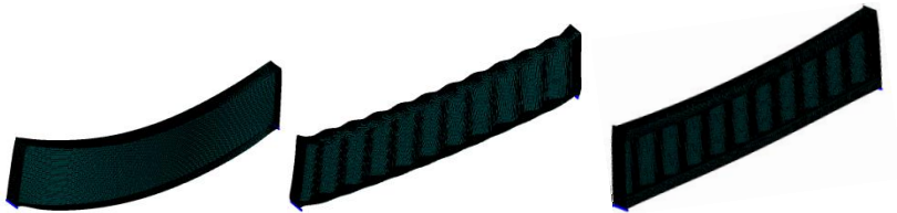
Рис. 3 Общий вид образцов № 1,2,3 после приложения равномерно распределенной нагрузки
