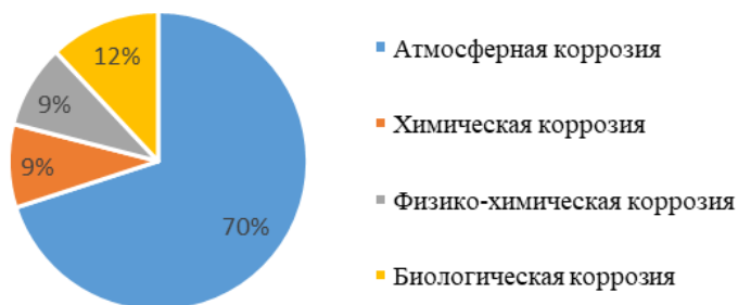
Рис. 1 Классификация коррозионных процессов
