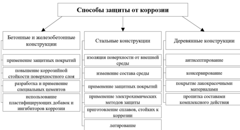
Рис. 2 Способы защиты строительных конструкций от коррозионных разрушений
