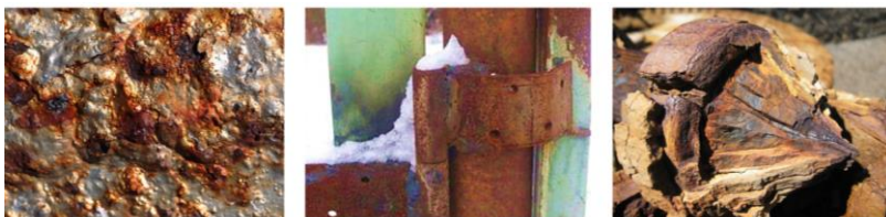
Рис. 1 Виды коррозии (по механизму протекания): а – химическая; б – электрохимическая; в – биологическая
