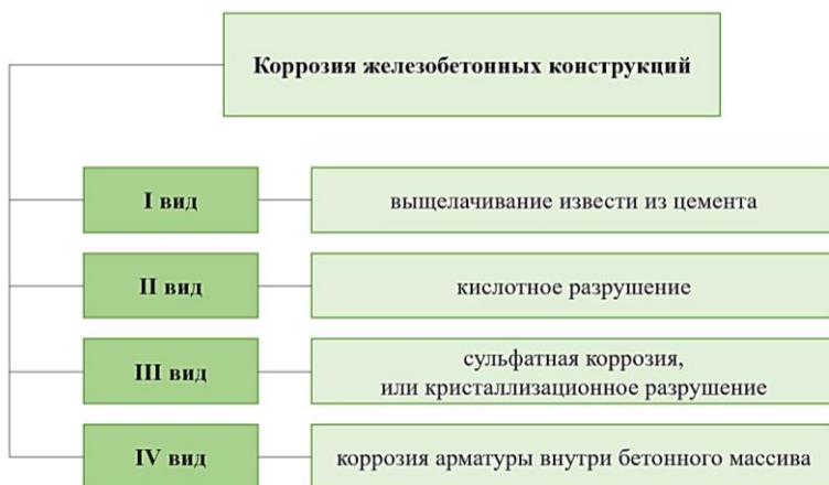
Рис. 3 Виды коррозии железобетонных конструкций
