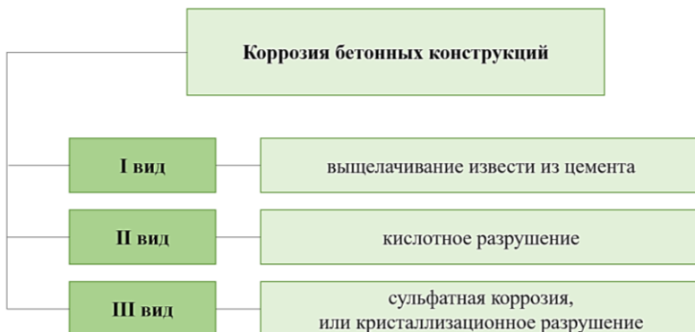
Рис. 2 Виды коррозии бетонных конструкций
