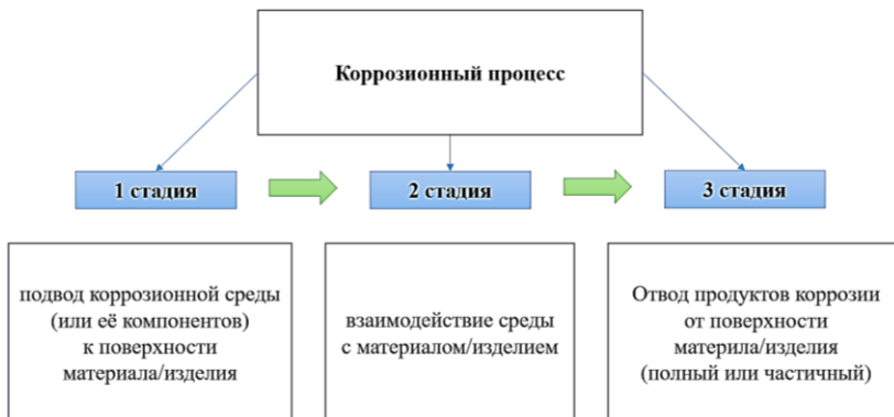
Рис. 2 Стадии коррозионного процесса
