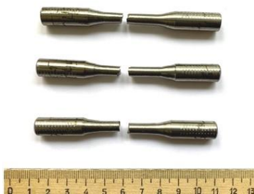
Рис. 2 Образцы после испытаний на одноосное растяжение
