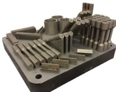
Рис. 1 Образцы для исследования, изготовленные по технологии селективного лазерного сплавления
