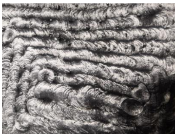
Рис. 1 Поверхностный слой наплавленного алюминиевого сплава
