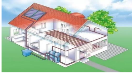
Рис. 3 Схема комбинированного использования солнечныхколлекторов и воздушного теплового насоса
