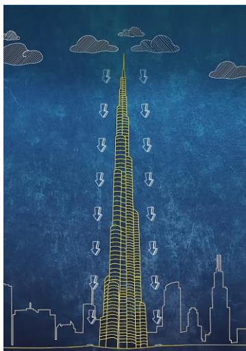
Рис. 3 Процесс разрядки удара молнии за счет огромного металлического каркаса башни.
