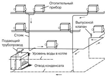
Рис. 1 Устройство парового отопления
