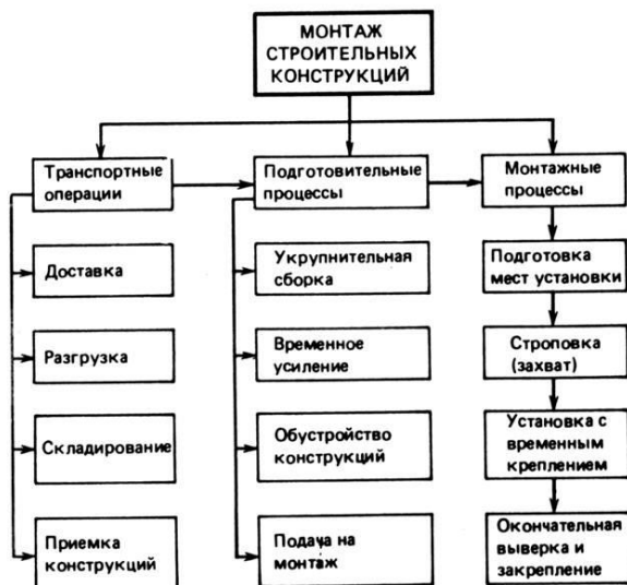
Рис. 1 Монтаж строительных конструкций
