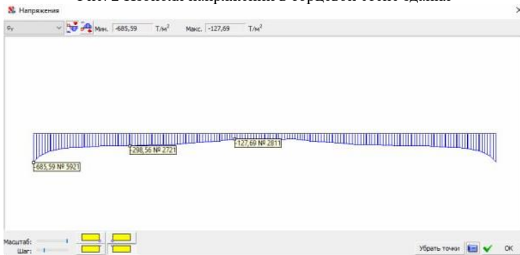
Рис. 3 Эпюра вертикальных напряжений в торцевой стене здания
