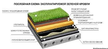
Рис. 3 Схема слоев зеленой крыши
