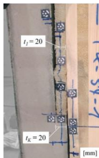
Рис. 8 Направление нагрузки перпендикулярно направлению волокон верхнего слоя
