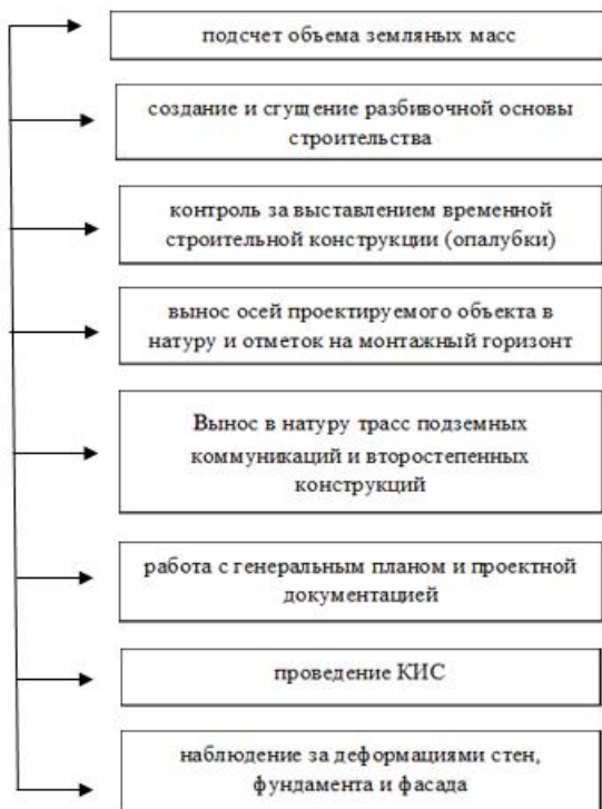
Рис. 1 Комплекс работ при геодезическом сопровождении
