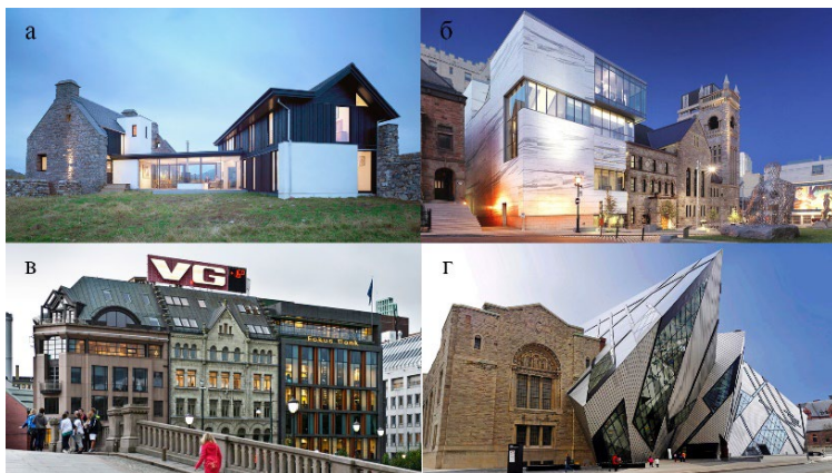
Рис. 1 Типы слияния новых и исторических зданий: а - симбиоз «старого и нового»; б - принцип подчинения; в - «вписывание» в историческую застройку; г - контраст;
