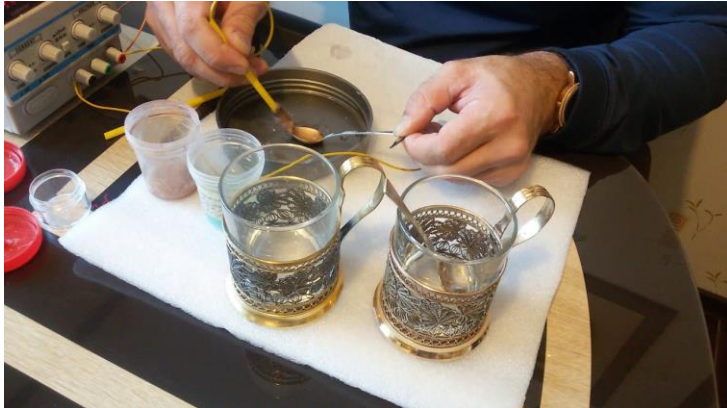
Рис. 5 Электролитический способ золочения ( https://www.youtube.com/watch?app=desktop&v=Aq78K46zJvw )
