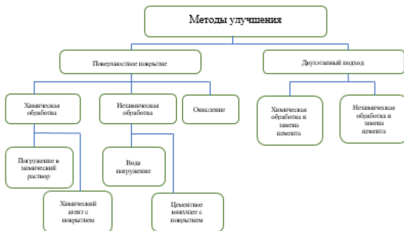
Рис. 1 Способ повышения свойств прорезиненного бетона.
