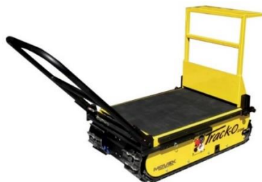
Рис. 5 Гусеничная тележка для разгрузочно-погрузочных работ Track-O Twin-Track 47
