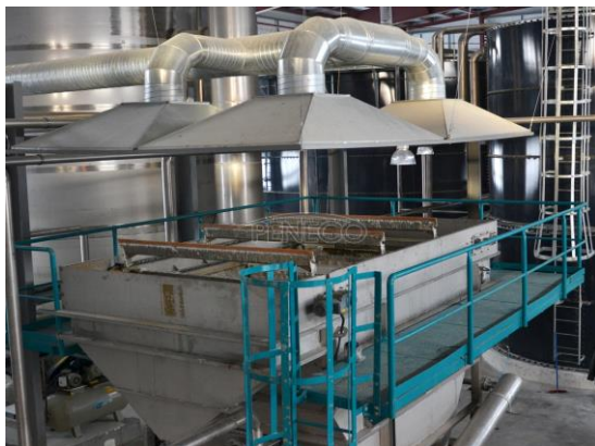
Рис. 3 Система физико – химической очистки воды
