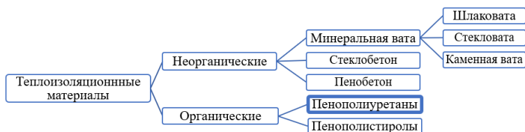
Рис. 1 Классификация теплоизоляционных материалов по виду исходного сырья
