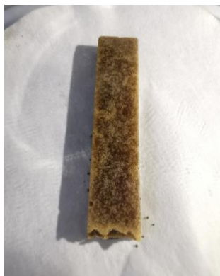
Рис. 1 Образец с наполнителем солома после месячной эксплуатации
