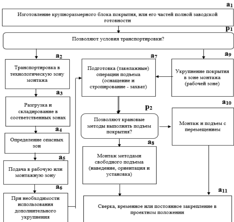
Рис. 1 Структура комплексного процесса монтажа крупноразмерных покрытий или их частей полной заводской готовности
