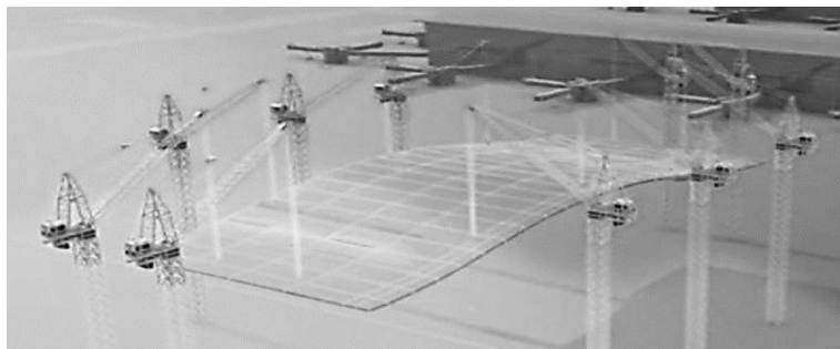
Рис. 2 Проектный вариант собранного в зоне монтажа большеразмерные покрытия с последующим поднятием его на проектные отметки десятью кранами
