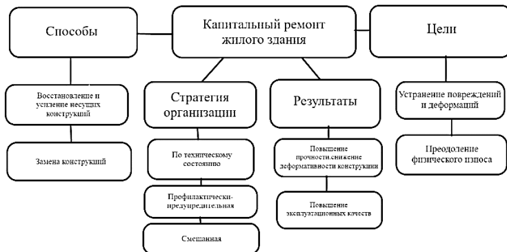
Рис. 2 Содержание капитального ремонта жилищного фонда
