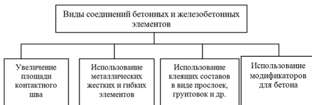
Рис. 4 Виды соединений бетонных и железобетонных элементов
