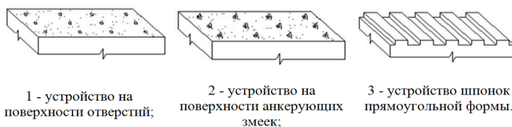
Рис. 7 Разновидности мероприятий по увеличению площади контактного шва
