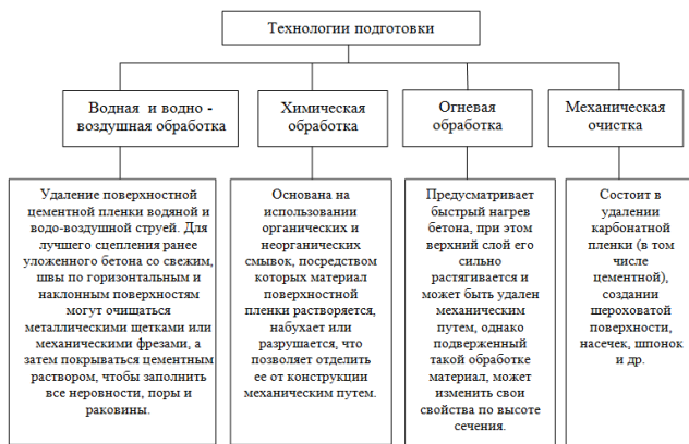
Рис. 6 Технологии подготовки поверхности контактного шва
