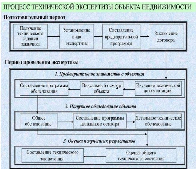
Рис. 5 Проведение тех. экспертизы объекта недвижимости
