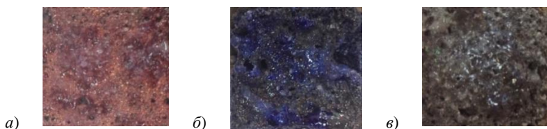
Рис. 3 Декоративные покрытия на мелкозернистом бетоне с солями: а – меди; б – кобальта; в – никеля
