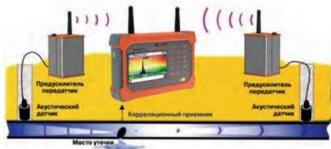
Рис. 1 Принцип работы корреляционно-акустического метода
