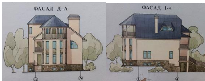
Рис. 1 Чертежи фасадов здания с построением теней. Фрагменты демонстрационного плаката.
