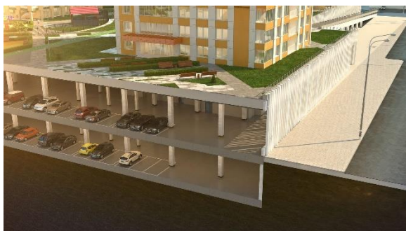
Рис. 2 Подземная парковка, размещённая под жилым домом
