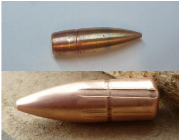
Рис. 5. Пуля до и после прохождения канала ствола.
