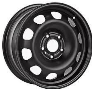
Рис. 1. Штампованный автомобильный диск.
