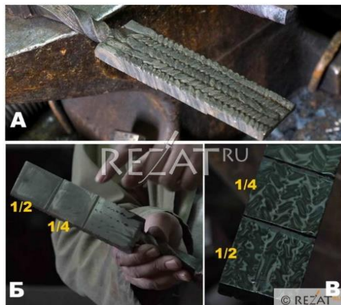
Рис. 7. Узоры турецкого дамаска: А — пакет из четырех скрученных в противоположных направлениях прутков; Б — сошлифовка \frac{1}{2} и \frac{1}{4} толщины пакета; В — узор при разной величине сошлифовки
