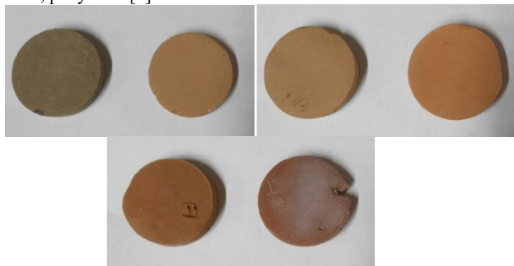
Рис. 1. Фазовые изменения оттенков керамических черепков в зависимости от градуса обжига. Сушка от 150\text{ }^\circ\text{C} , обжиг до 900\text{ }^\circ\text{C} .
