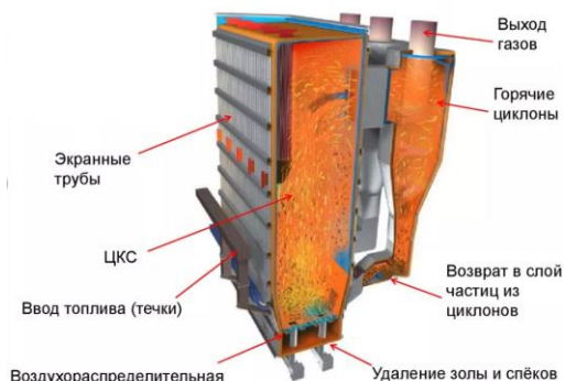
Рис. 2 Топка с циркулирующим кипящим слоем
