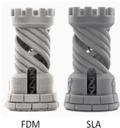
Рис. 3 Сравнение печати FDM и SLA
