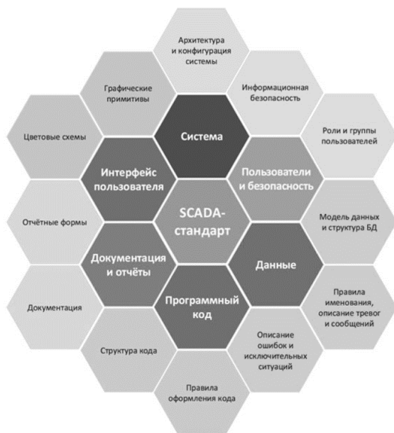
Рис. 1 Объекты и области стандартизации в SCADA-проектах
