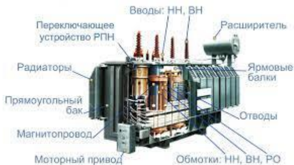
Рис. 1 Устройство масляного трансформатора
