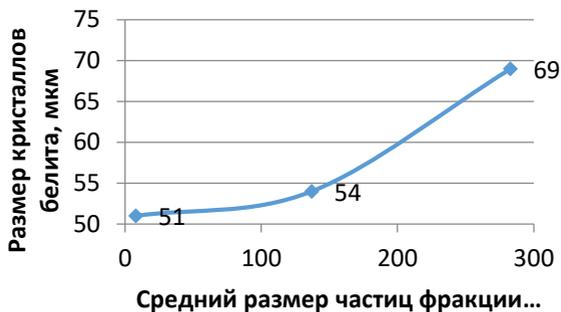
Рис. 5 График зависимости размеров кристаллов белита от среднего размера частиц фракции песка
