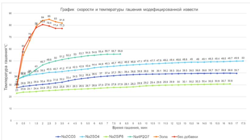
Рис. 1 Определение скорости и температуры гашения извести с различными добавками
