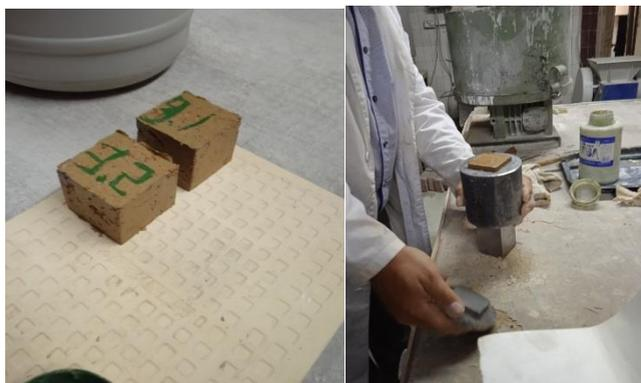
Рис. 2 Формование образцов
