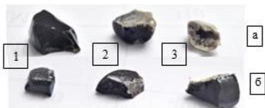
Рис. 1 Проявление кристаллизации экспериментальных стекол при термообработке: 1) 800°C и выдержка 1,5 ч; 2) 900°C и выдержка 1,5 ч; 3) 950°C и выдержка 2 ч: а) тип E<sub>3</sub>; б) тип S<sub>5</sub>
