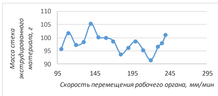
Рис. 3. График зависимости массы стека экструдируемого материала от скорости перемещения рабочего органа
