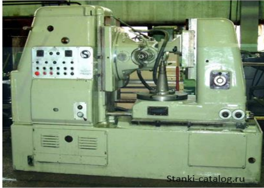
Рис. 2 Зубофрезерный станок модели 5K324
