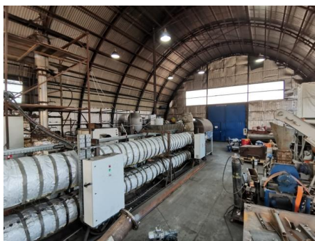
Рис.1 Термолизная линия с двумя камерами и отстойником
