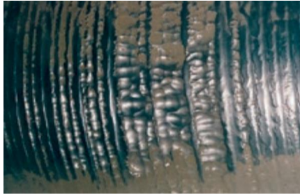
Рис. 1 Пример неравномерности износа валька
